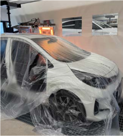
IR-Trocknen auf dem Multifunktionsarbeitsplatz
