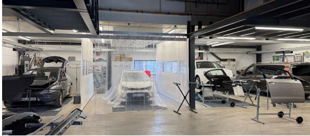
Die Universalvorbereitungsplätze bieten vielfältige Möglichkeiten, die Fahrzeuge für den Lackierprozess optimal vorzubereiten, vom Maskieren bis zum Zerlegen.
